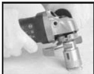
Poser le trépan légèrement incliné sur le point à percer et **effectuer des mouvements lents et circulaires avec la meuleuse d'angle**. De cette manière, on évite une surchauffe. **Observer des pauses de refroidissement.**
